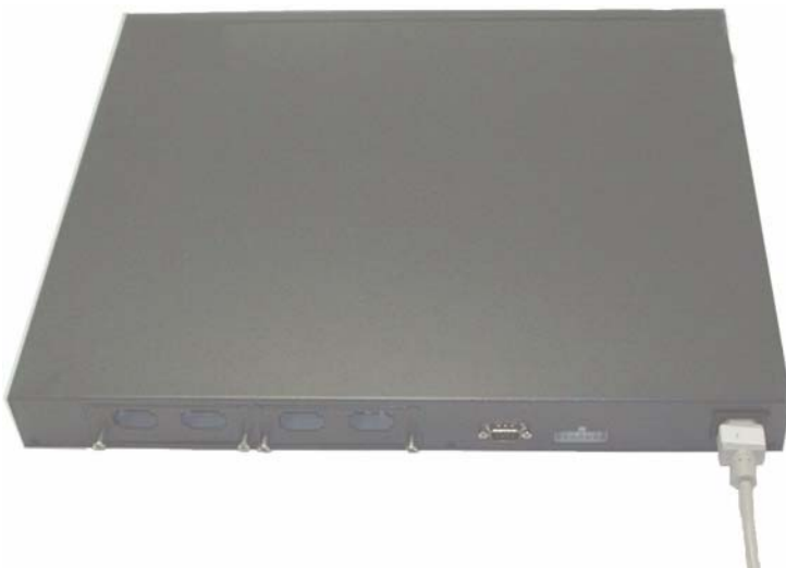
図 1-2 電源ケーブルの接続
